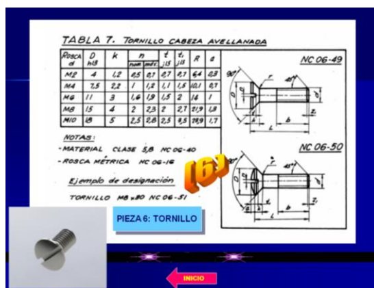
Fig. 4: Presentación visual con tabla parámetros de la pieza 6 (tornillo).
