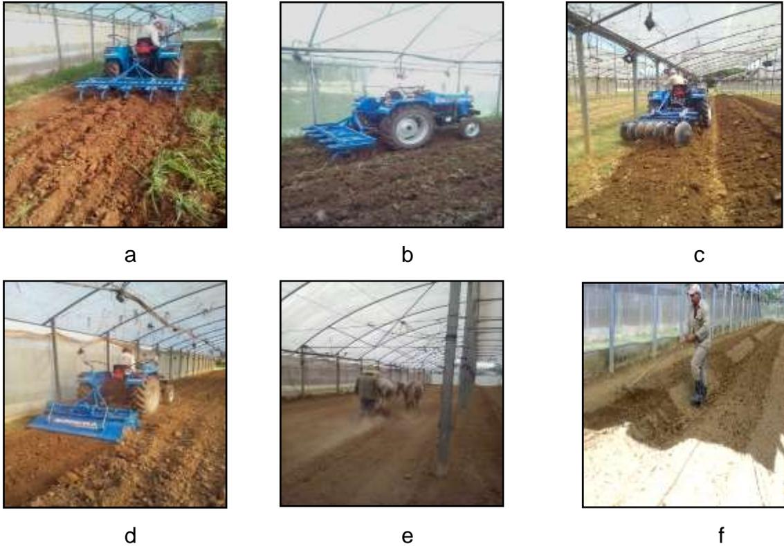
Figura 2. Labores realizadas: a y b) Eliminación de malezas) Gradeo; d) Rotovateado; e) Trazado de cantero; f) Conformación de cantero.
