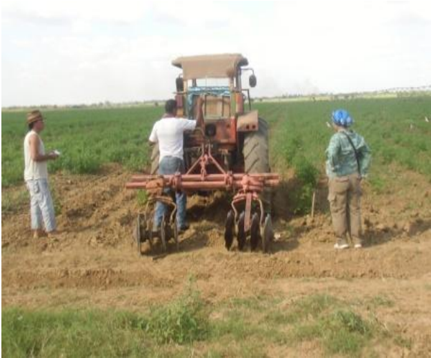
Figura 2. Labor de cultivo entre hilera: a) Escarificador (Tiller); b) grada de discos múltiple BP-206.
