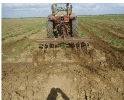
Figura 1. Labor de cultivo entre hilera: a) Escarificador (Tiller); b) Cultivador aporcador (SA-2).
