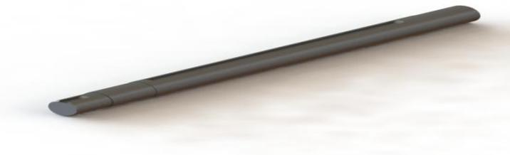
**Figura. 2. Modelo del árbol del molino triturador (SolidWorks 2014).**
