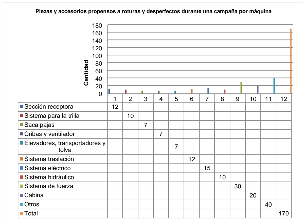
Figura 1. Piezas y accesorios propensos a roturas y desperfectos durante una campaña por máquina
