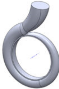
Figura 3. Campo de flujo correspondiente a la carcasa.
