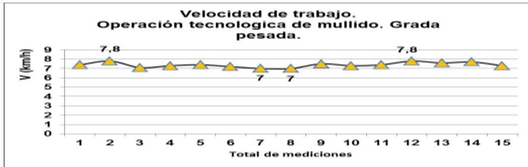
Figura 6. Velocidad de trabajo real del agregado formado por el tractor YTO X 1204 y la grada pesada Baldan de 52 discos.
