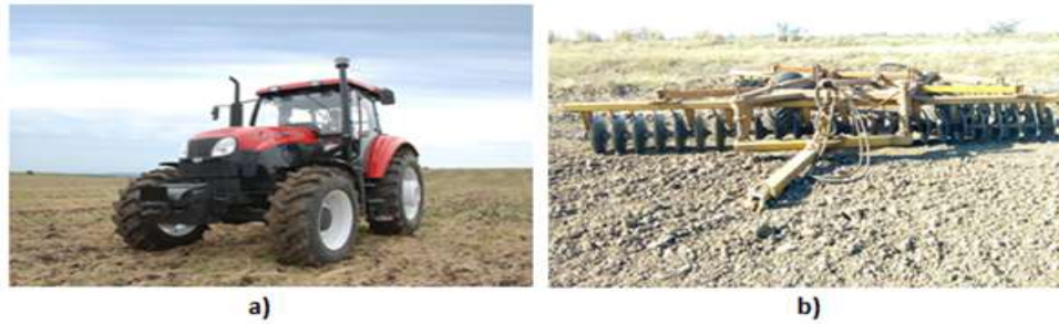
Figura 1. Tractor utilizado para formar agregado con las gradas y el alisador. a) Tractor YTO x1204. b) Grada Baldan pesada de 52 discos.
