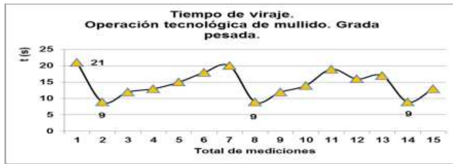
Figura 4. Tiempo de viraje del agregado formado por el tractor YTO X 1204 y la grada pesada Baldan de 52 discos.
