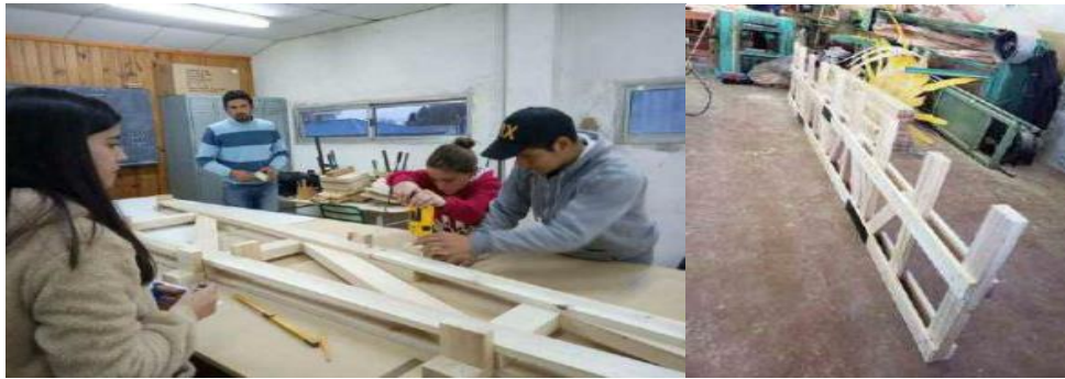
Figura 7. Taller de Producción de componentes prefabricados con madera de álamo en la Escuela Técnica Fuente: Proyecto PFIP (2018).
