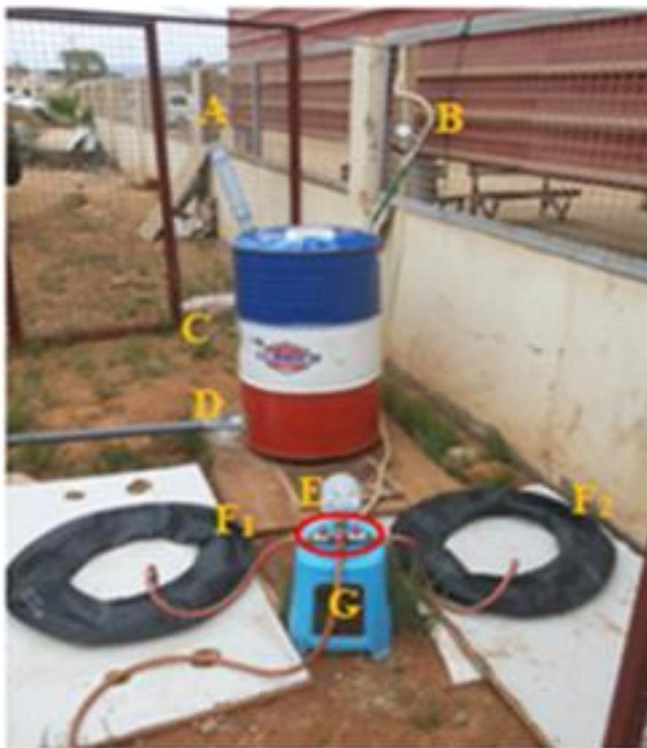
Fig. 2. Biodigestor ISPKS-2018.
